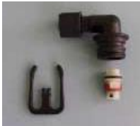
BLFC 110 ltr/h nur offen beim Spülen (Ventil schließt beim Füllen und öffnet beim Spülen, erlaubt größere Flußgeschwindigkeiten zum Kanal) Verschlussclip für einfache Demontage
